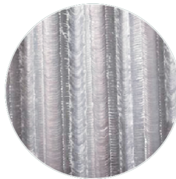
水管耐腐蚀层堆焊技术
