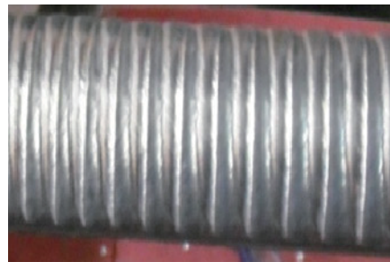
单管堆焊技术
